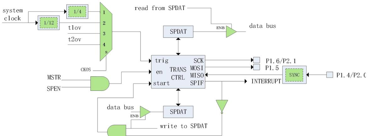
图 19-1-1 SPI 主机模式示意图
