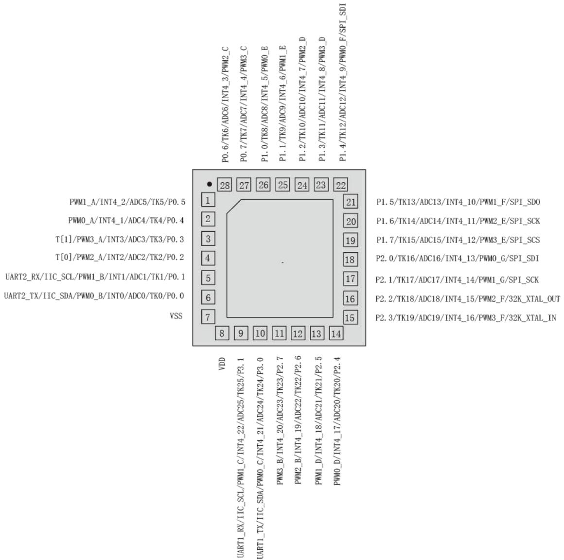
图 5-1-3 QFN28 封装引脚图
