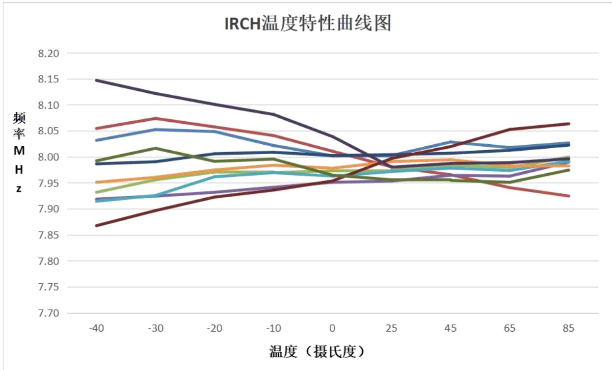
图 23-5-1 IRCH 温度特性曲线图
