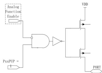
图 15-1-4 I/O 上拉模式结构示意图
