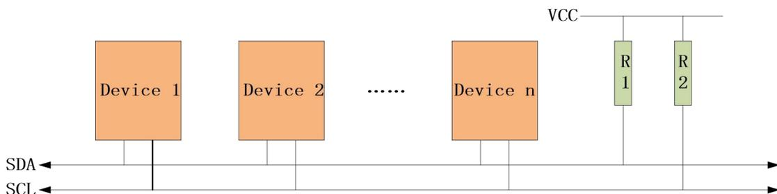
图 17-3-1 I<sup>2</sup>C 总线互连图
