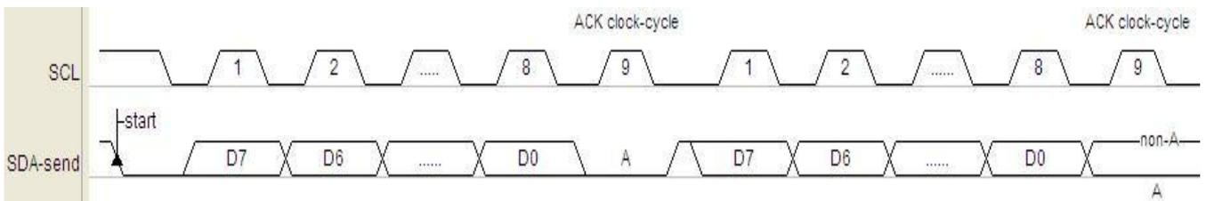
图 17-3-3 I<sup>2</sup>C 总线数据传输格式
