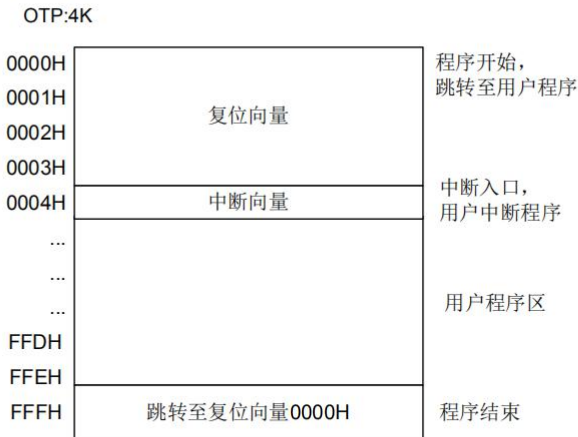
图 13. JZRT202 芯片程序存储器空间
